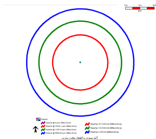
شکل ۴. آتش‌سوزی و انفجار مخزن بنزین انبار نفت با نرم‌افزار PHAST
